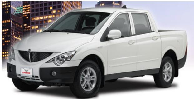
Phoenix Motor Cars<sup>16</sup> commercialise un véhicule utilitaire sportif à destination des entreprises et des flottes gouvernementales. Ce véhicule a un moteur de 60 kW (160 ch, 260 Nm), des batteries lithium-ion LFP<sup>17</sup> et une autonomie d'environ 120 km. Le véhicule peut se charger en 5 à 6 heures sur du 220 Volts ou en environ 1 heure avec un chargeur rapide.
