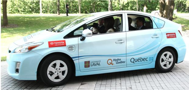
avec Panasonic qui lui permettent de rouler sur 21 km en mode tout électrique avec une vitesse maximale de 100 km/h.
