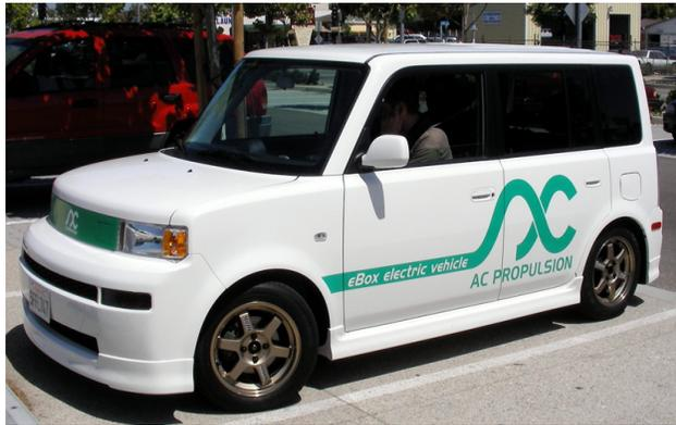
La eBox d'AC Propulsion<sup>23</sup> est une conversion d'une Toyota Scion xB à un véhicule tout électrique avec leur technologie tzero™. Elle est équipée d'un moteur électrique de 150 kW (200 ch) et de batteries lithium-ion totalisant 35 kWh pour une autonomie de 230 à 290 km. Elle réalise un 0 à 100 km/h en 7 secondes et peut atteindre 153 km/h en pointe. Elle peut être rechargée en 2 à 5 heures. Cette voiture est particulièrement intéressante puisqu'elle présente des capacités
