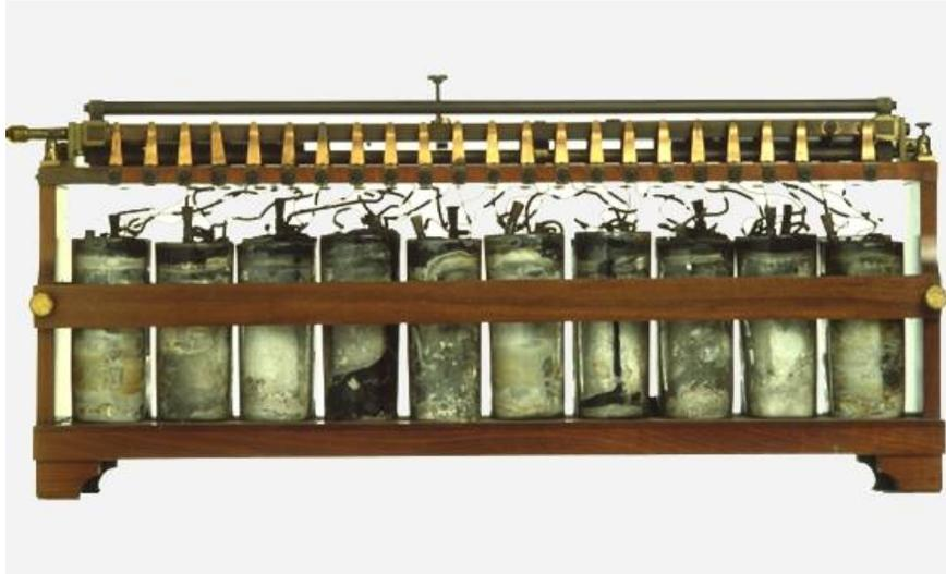
FIGURE 2.1 – L'accumulateur expérimental de Gaston Planté.[4]
