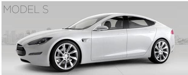
La Tesla Model S est une berline dont la commercialisation est prévue pour 2012. Sur la même base technologique que le Roadster mais avec une allure d'Aston Martin elle devrait avoir une autonomie de 480 km et se recharger en 3 à 5 heures avec l'adaptateur 240 Volts ou en 45 minutes avec un adapta-
