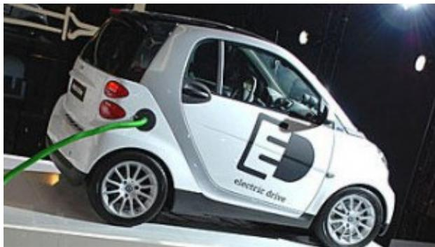
La Smart For Two ED (Electric Drive) dispose d'un moteur de 41 chevaux pour une vitesse de pointe de 112 km/h et une autonomie de 135 km. Elle se recharge complètement en 8 heures. Actuellement en phase de tests, elle est fabriquée en France et prévue pour la commercialisation au grand public en 2012.<sup>9</sup>
