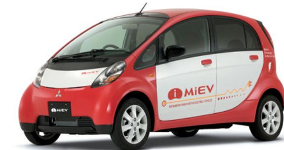
La mitsubishi I-miev dispose d'un moteur de 47 kW (180 Nm) et d'une batterie Lithium-ion de 16 kWh pour une autonomie de 160 km. Elle peut être chargée via deux prises, une pour une connexion domestique (100 à 200 Volts) avec un temps de charge d'environ 7 heures pour du 200 Volts et une prise recharge rapide avec un temps de charge d'environ 30 minutes.<sup>10</sup> HydroQuébec effectue des tests routiers de ce modèle à Boucherville<sup>11</sup>.
