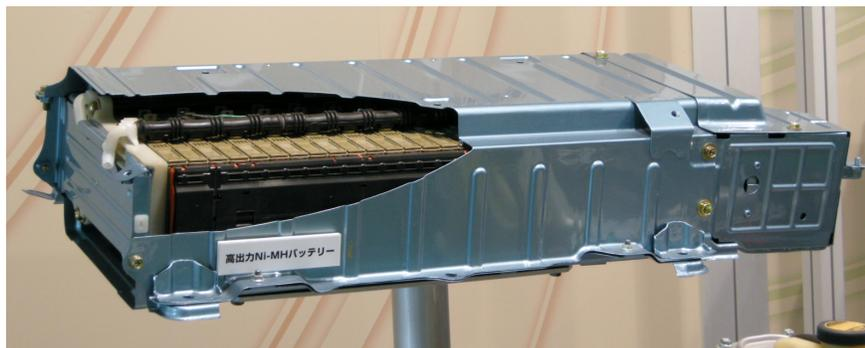
FIGURE 2.3 – Batterie Ni-Mh d'une Toyota Prius
