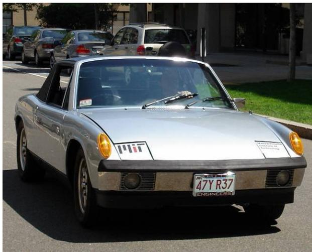
La Porsche 914 BEV<sup>25</sup> est une conversion d'une Porsche 914 en véhicule électrique par l'équipe EVT<sup>26</sup> du MIT. Elle dispose d'un moteur de 55 kW d'Azure Dynamics<sup>27</sup> et de batteries lithium-ion phosphate de Valence Technology<sup>28</sup> pour une autonomie de 160 km. Elle est rechargeable en 2 heures et demi à 8 heures dépendant de la puissance du chargeur.
