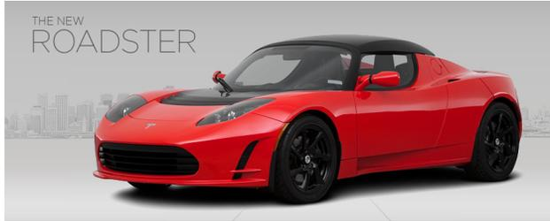
La Tesla Roadster dispose d'un moteur de 185 à 215 kW (248 à 288 ch, 270 Nm) et de batteries Lithium-ion d'une capacité de 53 kWh pour une autonomie de 340 km et des accélérations entre 0 et 100 km/h en seulement 3.7 secondes. Plusieurs moyens de recharge sont proposés par Tesla, la recharge
