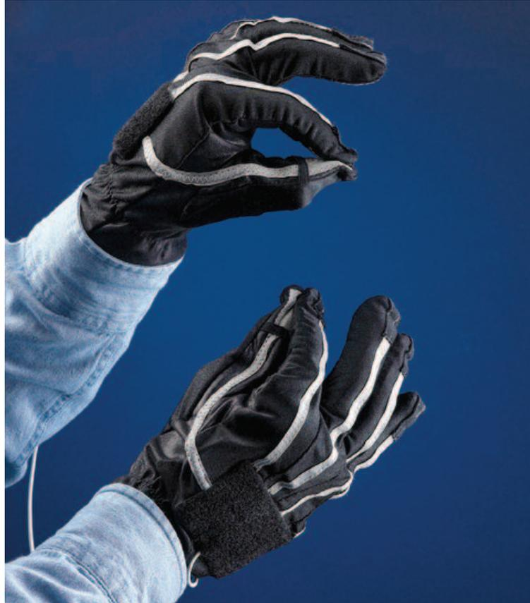
FIG. 2.1 – Gant de RV *Pinch Glove* de la compagnie *Fakespace Systems inc.* [22] permettant l’interactivité avec les éléments constitutifs d’un monde virtuel.
