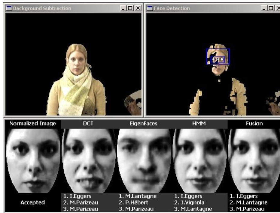
**Fig. 3.4:** Interface de l'application de reconnaissance multi-classifieur d'individu. L'interface principale contient trois fenêtres représentant les résultats de la soustraction de l'arrière-plan (nord-ouest), de la détection du visage (nord-est) et de l'identification (sud). Cette dernière contient notamment le visage détecté normalisé à l'extrême gauche suivi des résultats pour les méthodes individuelles (DCT, EigenFaces, HMM) et par la fonction de décision (Fusion).
